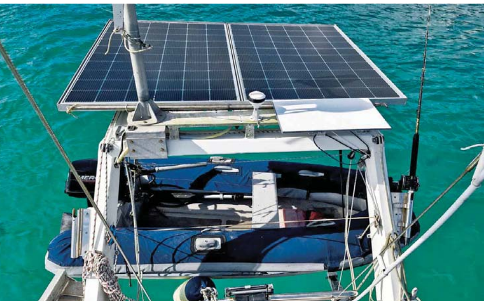
Rampa s konstrukcí na solární panely a dinghy na jeřábu
