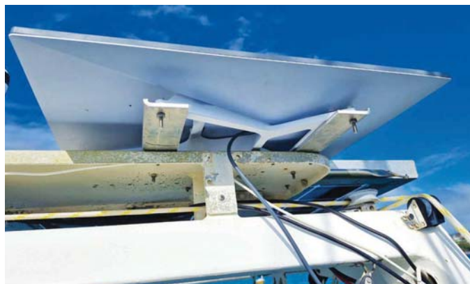
Nová anténa Starlink na zadní rampě SNĚHURKY
